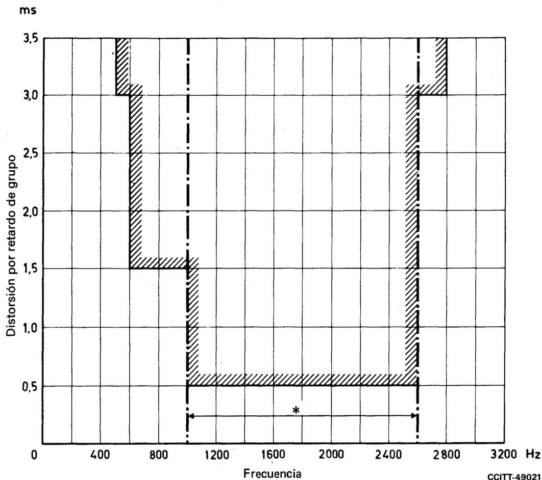
\* Banda de frecuencias con características definidas para el sistema de señalización N.º 6. La plantilla de tolerancias es la de la Recomendación M.1020,
