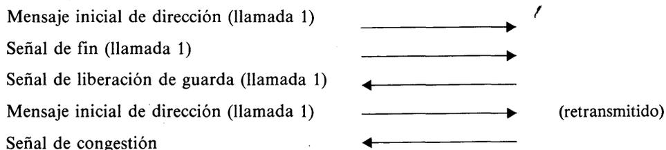
El procesador que reciba la señal de congestión hallará el circuito asociado en condición de reposo y supondrá que la señal no es válida. El procesador del otro extremo mantendrá ocupado el circuito en espera de la señal de fin.
