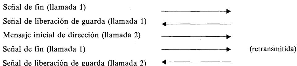
El equipo de tratamiento que recibe la señal de liberación de guarda ignora si se trata de la respuesta a una señal de fin retransmitida o si se debe a un error entrante no detectado.
