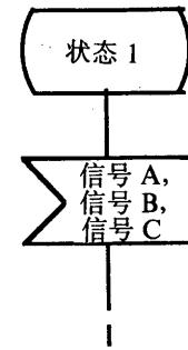
b) 使用一个输入符号的多个输入信号举例
