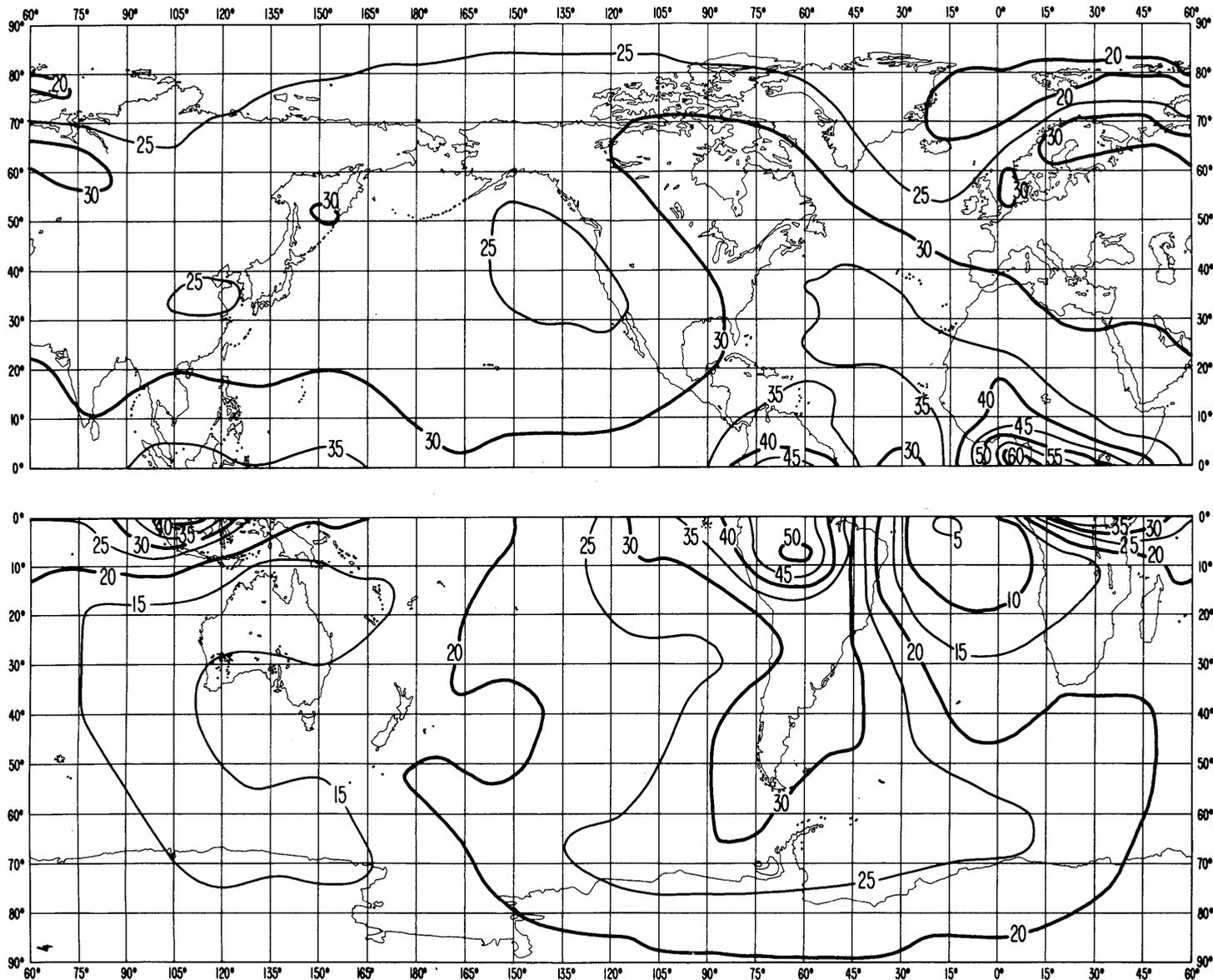
FIGURA 4a – Valores probables del ruido atmosférico,  $F_{am}$ , en dB por encima de  $kT_0b$  en 1 MHz
