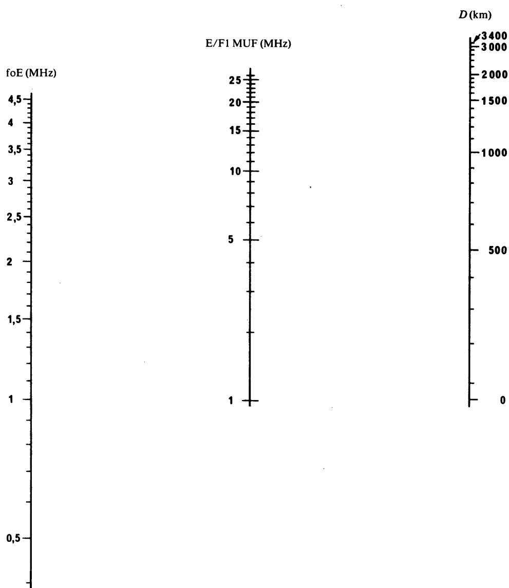
FIGURA 15 – Nomograma que permite transformar  $f_{\text{o}}\text{E}$  en E/F1 MUF básica a una distancia  $D$
