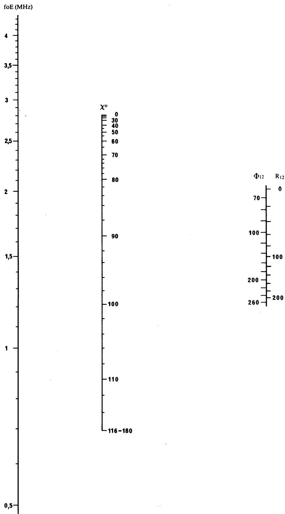
FIGURA 14 — Nomograma para obtener  $foE$  para un valor medio del número de manchas solares obtenido a lo largo de doce meses,  $R_{12}$ , o flujo radioeléctrico solar,  $\Phi_{12}$ , y la distancia cenital del Sol  $\chi$
