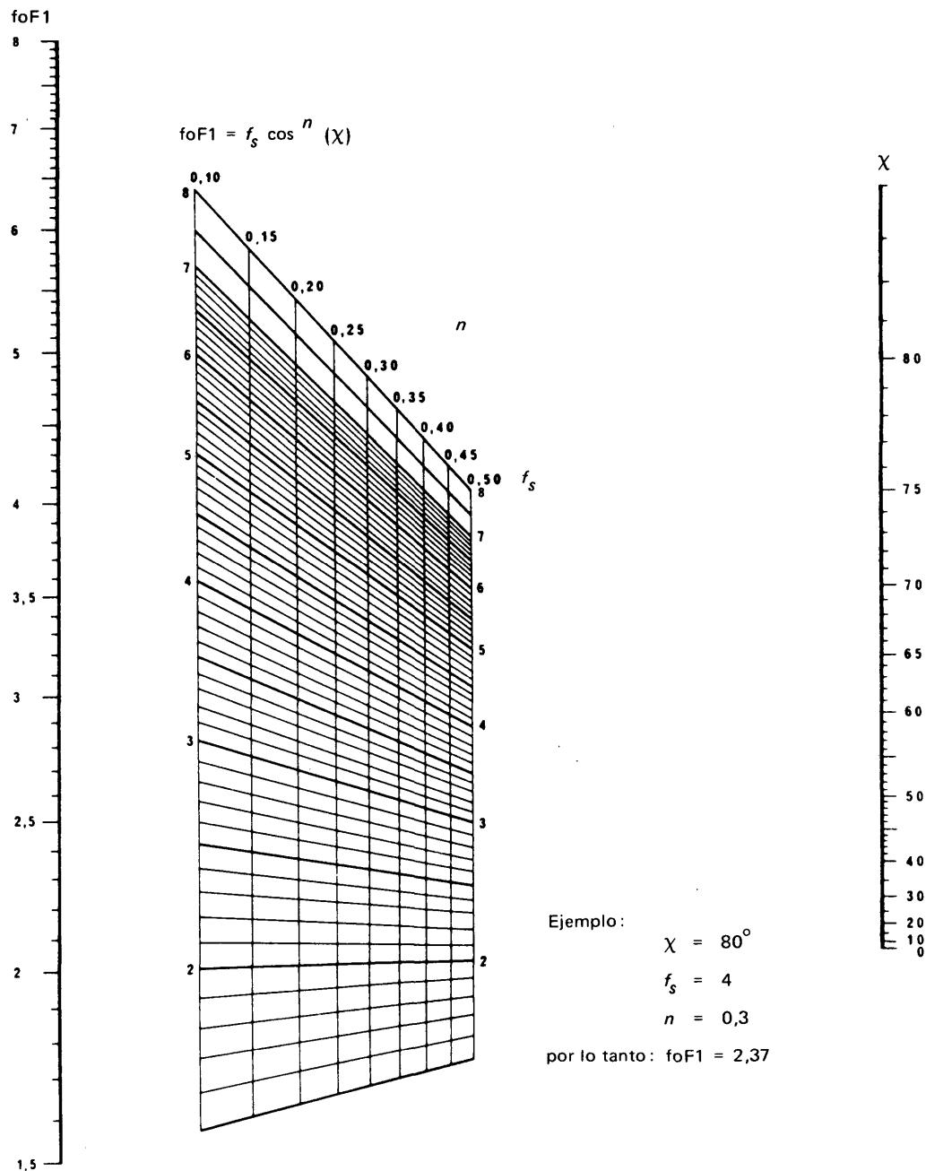
FIGURA 6 – Nomograma para la determinación de  $foF1$
