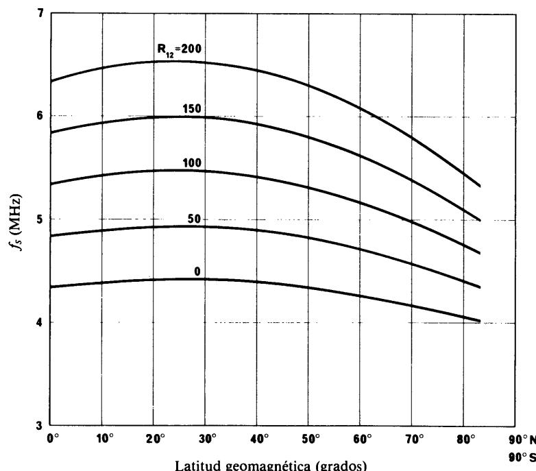
FIGURA 3 – Variación de  $f_s$  en función de la latitud geomagnética y de  $R_{12}$
