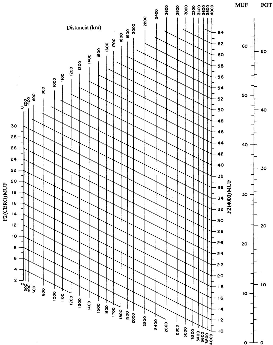
**FIGURA 12** – Nomograma para transformar la  $F2(\text{CERO}) \text{ MUF}$  y la  $F2(4000) \text{ MUF}$  en MUF básicas equivalentes para las distancias intermedias de transmisión
