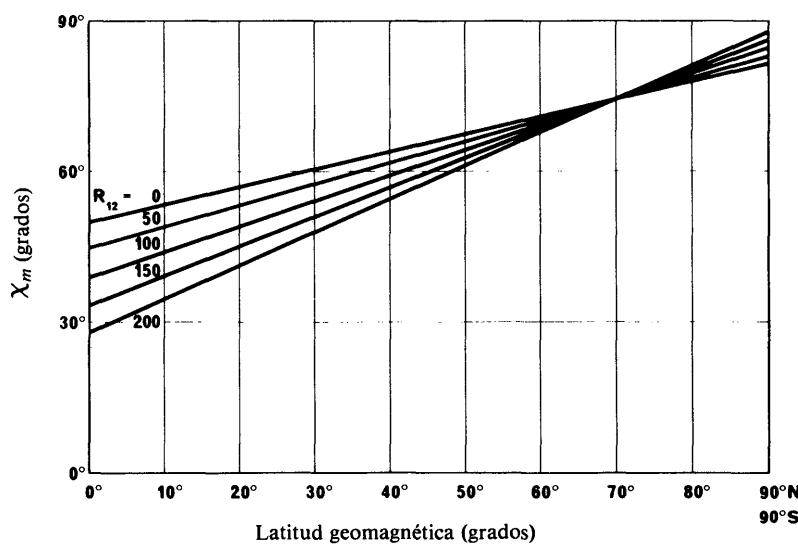
FIGURA 5 – Variación de  $\chi_m$  en función de la latitud geomagnética y de  $R_{12}$
