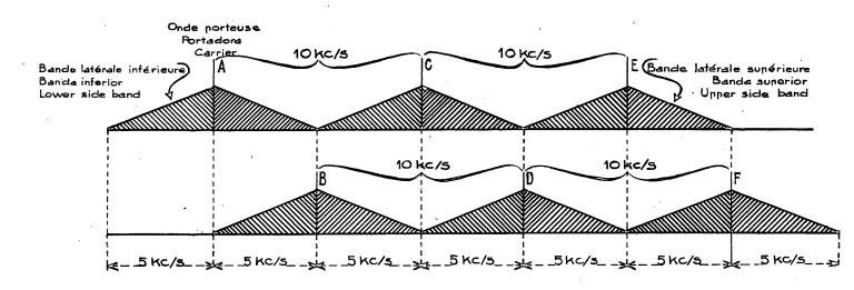
Les voies "A", "C" etc., sont géographiquement séparées des voies "B", "D", etc., La séparation géographique tiendrait compte de l'emplacement de l'émetteur, de la directivité de l'antenne, de l'emplacement des zones de reception, et des facteurs de propagation appropriés.
