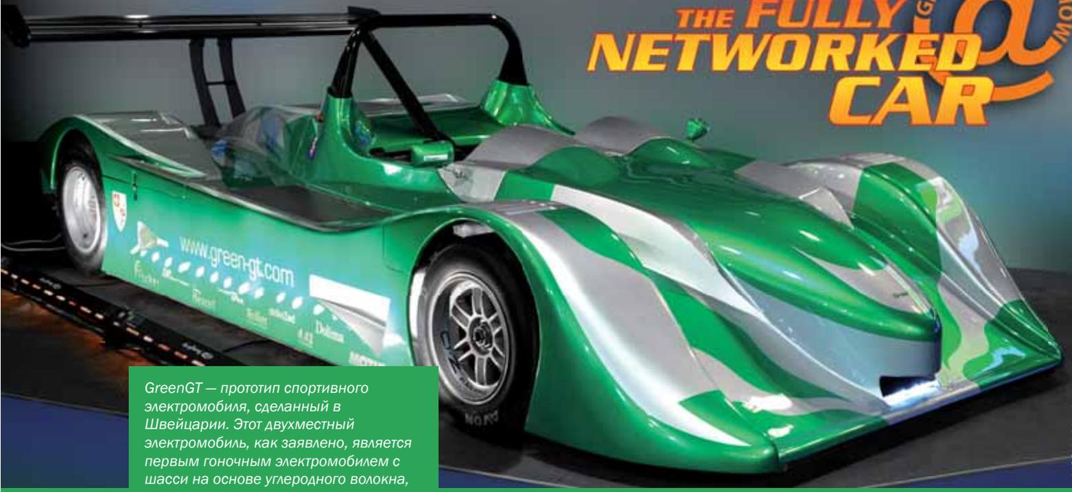
*GreenGT — прототип спортивного электромобиля, сделанный в Швейцарии. Этот двухместный электромобиль, как заявлено, является первым гоночным электромобилем с шасси на основе углеродного волокна, аналогичным используемому в автомобилях участников "Формулы-1"*
