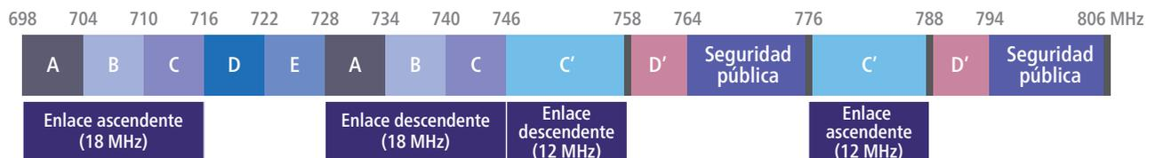
\* En Estados Unidos, la banda de 700 MHz está dividida en segmentos de banda superiores e inferiores y cada uno de los cuales contiene bloques C y D. En este diagrama, C' y D' representan los bloques C y D del segmento de banda superior. En febrero de 2012, el bloque D fue atribuido a la seguridad pública.
