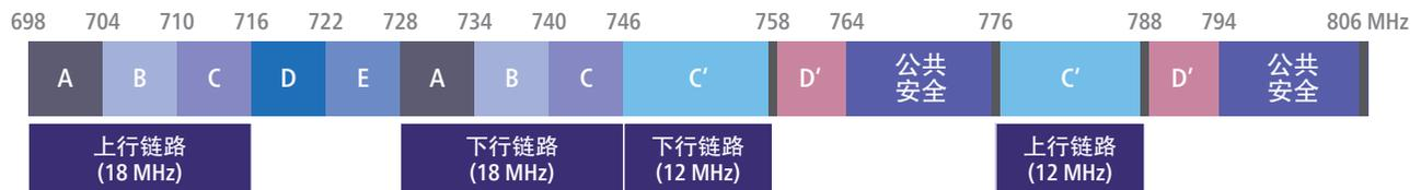
\* 美国700 MHz频段被分为高低两个频段，二者均包含C和D频率块。在本示意图中，C'和D'表示高频段中的C和D频率块。D'频率块于2012年2月被划分用于公共安全。
