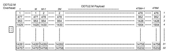
Figure 19-27 – ODTU2.M GMP byte numbering
