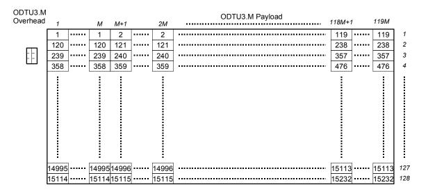
Figure 19-28 – ODTU3.M GMP byte numbering
