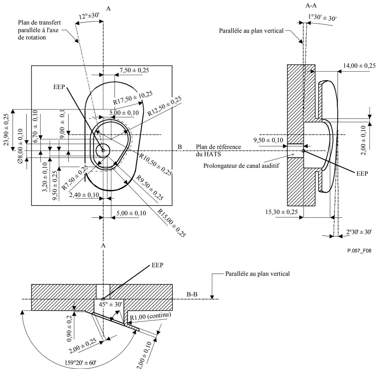
Figure 8/P.57 – Oreille artificielle de type 3.4
