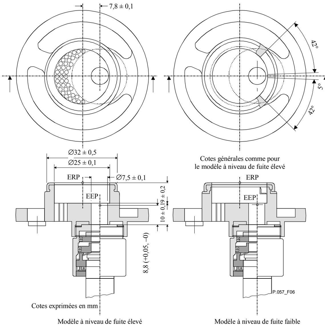
**Figure 6/P.57 – Exemple de simulateur de pavillon simplifié à niveaux de fuite élevé et faible pour casque d'essai LRGP**
