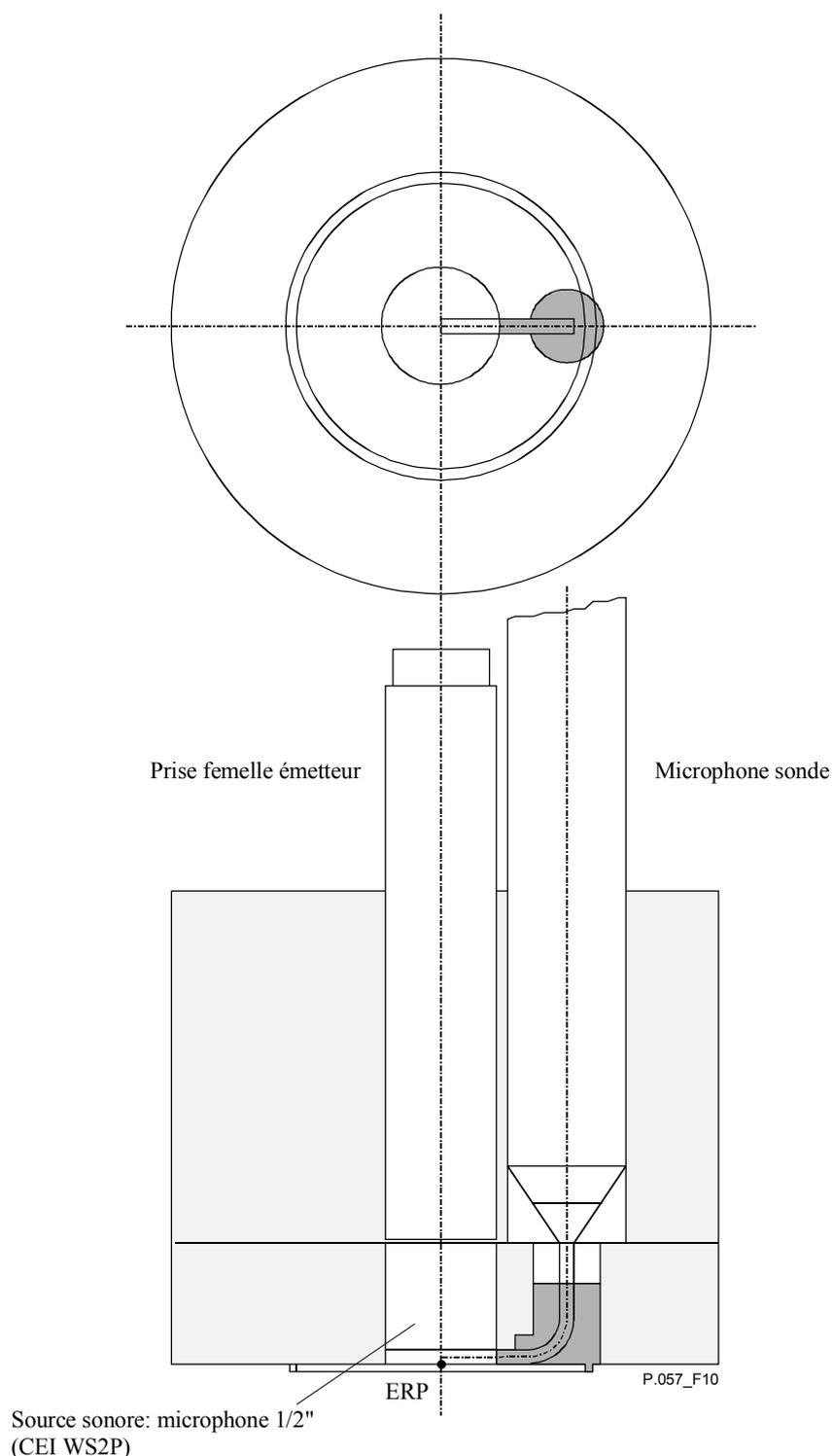
**Figure 10/P.57 – Installation d'un dispositif d'étalonnage (sonde d'impédance) pour la mesure de l'impédance acoustique d'entrée des oreilles artificielles de types 1 et 3.2**
