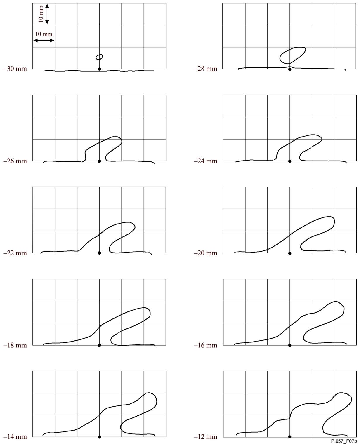
**Figure 7b/P.57 – Coupes du simulateur de pavillon**
