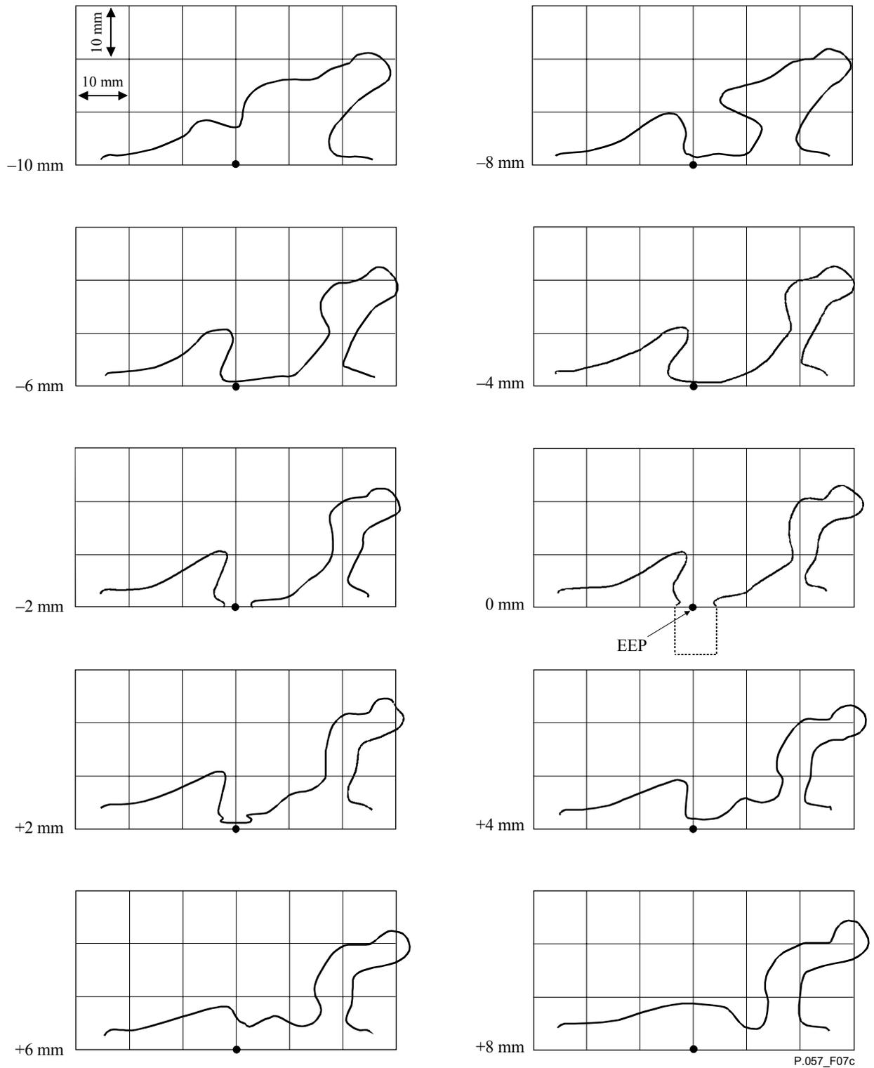
**Figure 7c/P.57 – Coupes du simulateur de pavillon**
