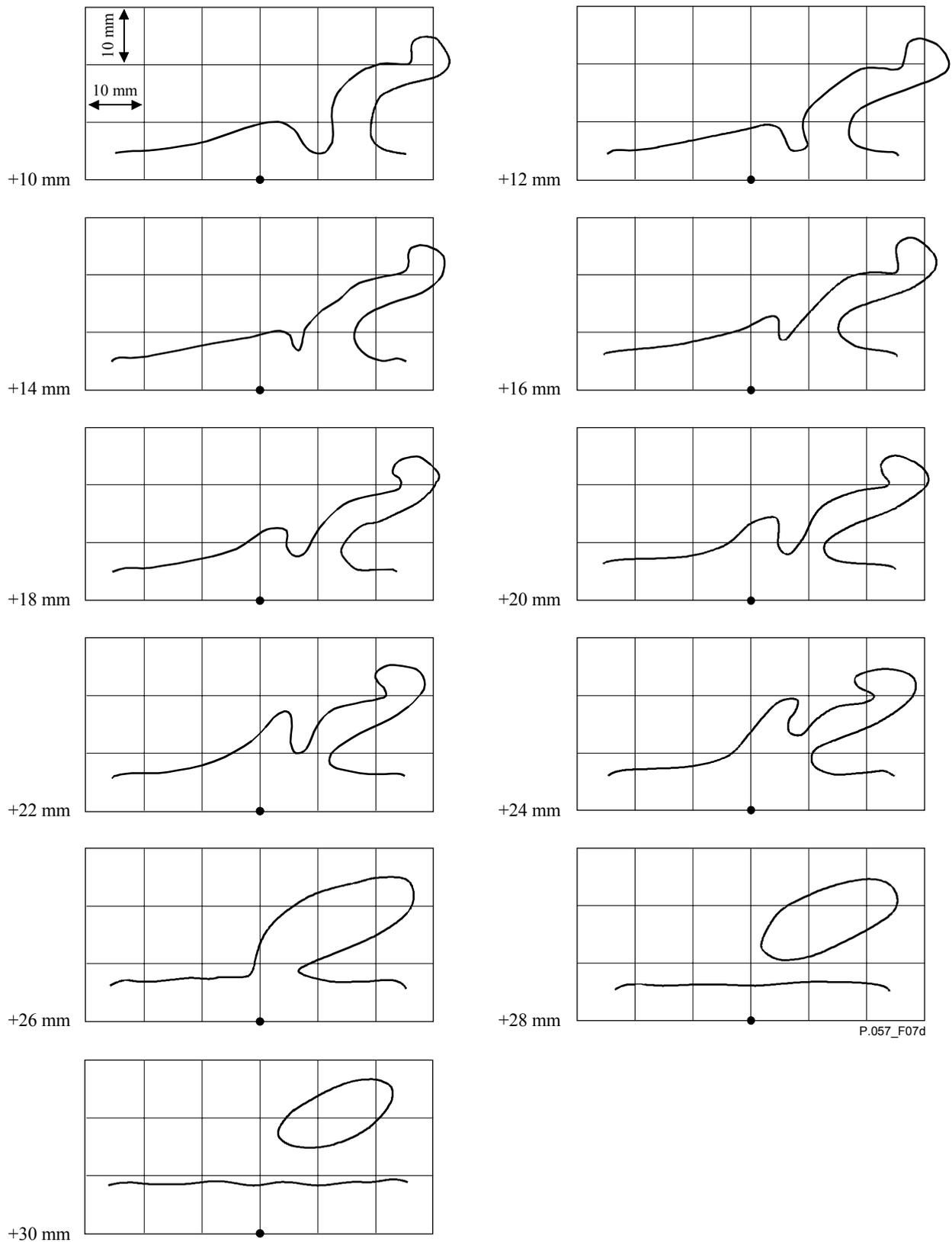
**Figure 7d/P.57 – Coupes de simulateur de pavillon**
